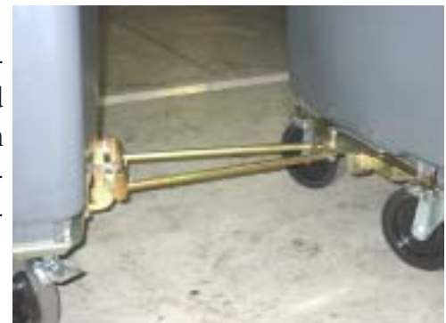
660L med drag och förstärkta hjul för tåg med upp till 5 kärl. Hjulen kan även fås som "non-marking" för bruk t.ex. i sjukhusmiljöer.
